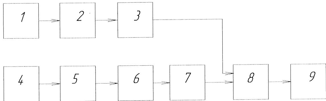
1-Датчик температуры; 2-усилитель; 3-компаратор; 4-термобатарея;
