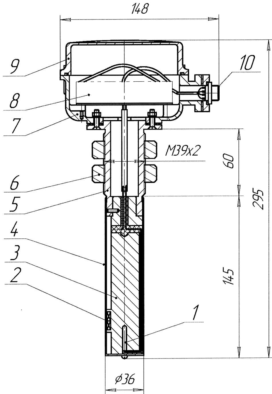
1-терморезистор; 2-термобатарея; 3-корпус;
